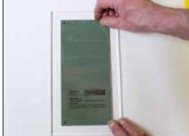
1.7 Gelochte Filmmontagefolie an den ausgeschnittenen Stellen mit transparentem Klebestreifen auf dem record-Spezial-Klischee fixieren. Das Klischee mit fixiertem Film von Filmmontageplatte entfernen.
