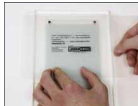
1.1 Enganchar la lámina de montaje de la película perforada en los 4 pasadores de ajuste de la placa de montaje de la película.
