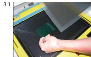
3.2 Schalter Vakuumpumpe des Flachbelichters einschalten. Luftblasen zwischen Klischee und Vakuumfolie mit dem Handrücken unter leichtem Druck ausstreichen, Flachbelichter schließen.
